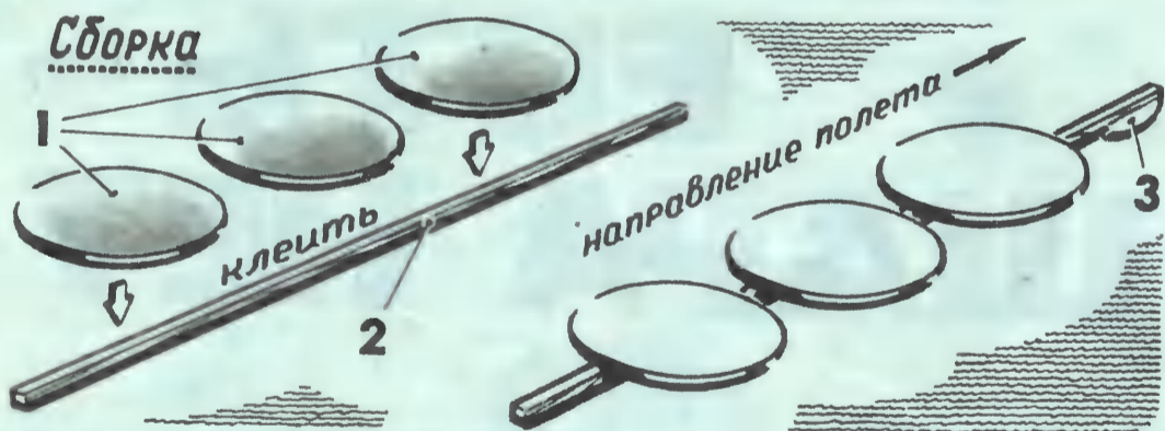
Рис. 2. 1 — диски из плотной бумаги; 2 — деревянная рейка; 3 — груз (пластилин).
